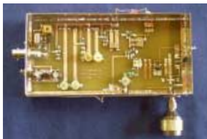
Le convertisseur 2,4GHz/144 MHz de F1BBU
